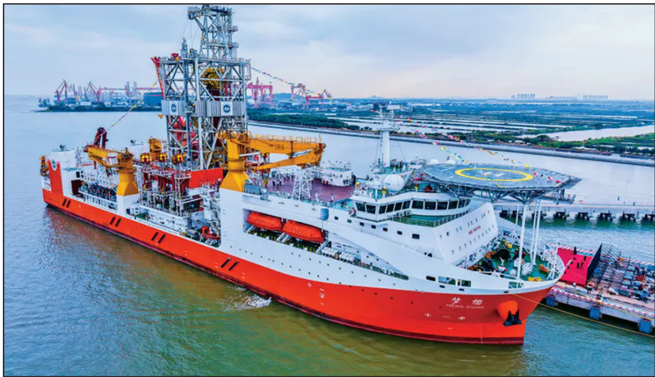
2024年11月17日，拥有最大11000米的钻深能力、我国自主设计建造的首艘大洋钻探船“梦想”号在广州正式入列，标志着我国深海探测关键技术装备取得重大突破。图为当日拍摄的靠泊在广州海洋地质调查局科考码头的大洋钻探船“梦想”号。
